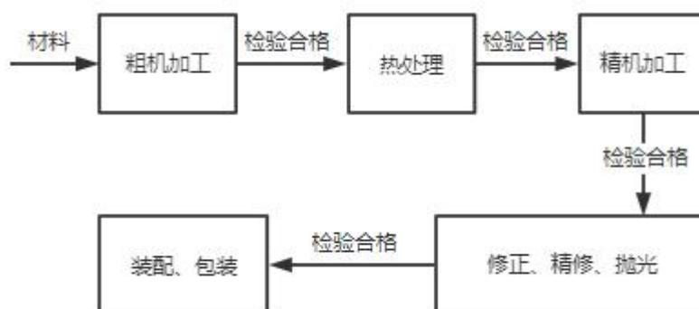
图 1 压铸模具生产工艺流程图
